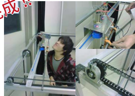
アルミ部材の加工 アルミ部材の四隅を加工し、直方体の枠組みを作る
