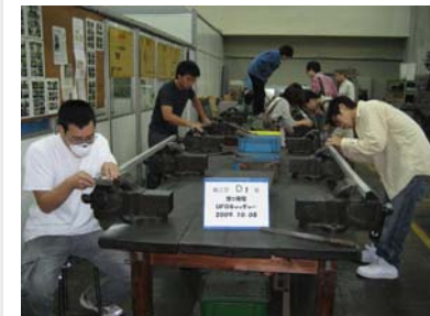
アルミ部材の加工 アルミ部材の四隅を加工し、直方体の枠組みを作る
